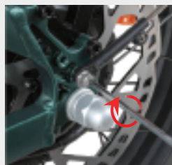
Insérer la bande de fixation du garde-boue arrière dans le sens et serrer les vis.
