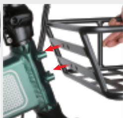
Alinee la cesta de la compra con el orificio del tornillo e inserte el tornillo
