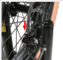
Coloque la pinza en el freno de disco
