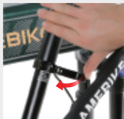
Appuyez sur la boucle de pliage (Notez que la hauteur de la barre ne peut pas dépasser la marque la plus haute)
