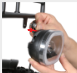
Placer les phares avant et les vis dans la bonne direction.
