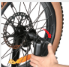
Premere con forza il morsetto a sgancio rapido per garantire la tenuta.
