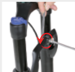
Démonter l'aile avant
