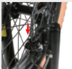
Posizionare la pinza nel freno a disco
