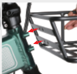
Aligner le panier sur le trou de la vis et insérer la vis.
