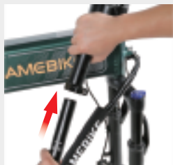
Insérer la poignée dans le sens de la flèche
