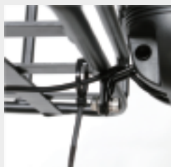
Sujeta el cable con una brida
