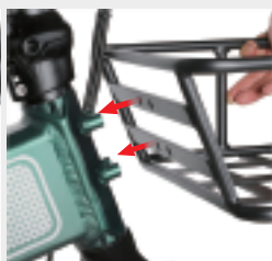
Allineare il cestino al foro della vite e inserire la vite.
