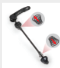
Retirer le collier de serrage rapide en faisant attention à la direction du ressort.
