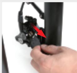
Retirer le joint du frein à disque
